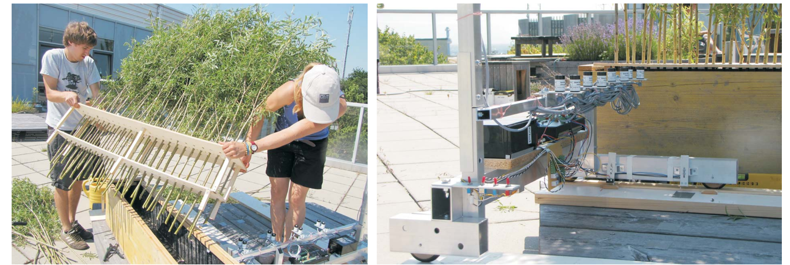
Abb. 1: Aufbau des Modellversuches (links: Stecksystem; rechts: Messroboter mit den Strahlungssensoren)
