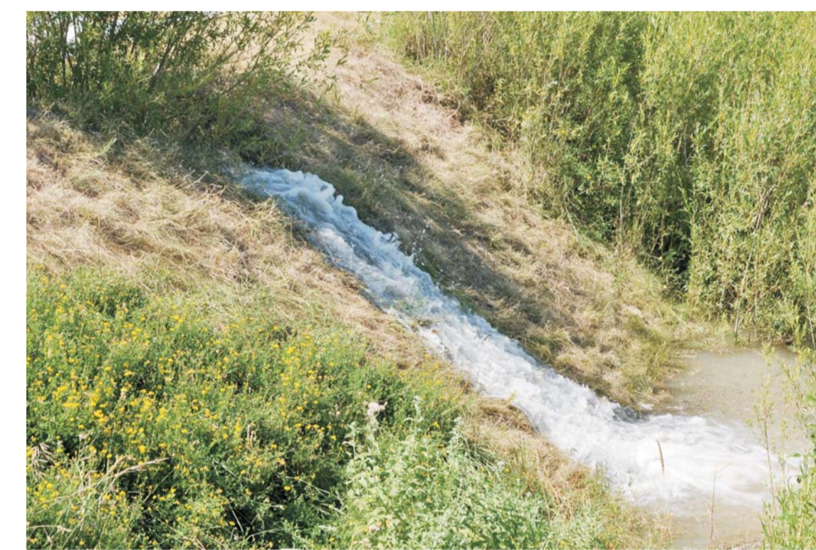
Abb. 6: Überströmung der Gräser-Kräuter-Vegetation mit 50 l pro Sekunde und lfm Damm (Deutsch-Wagram, Juli 2010).
