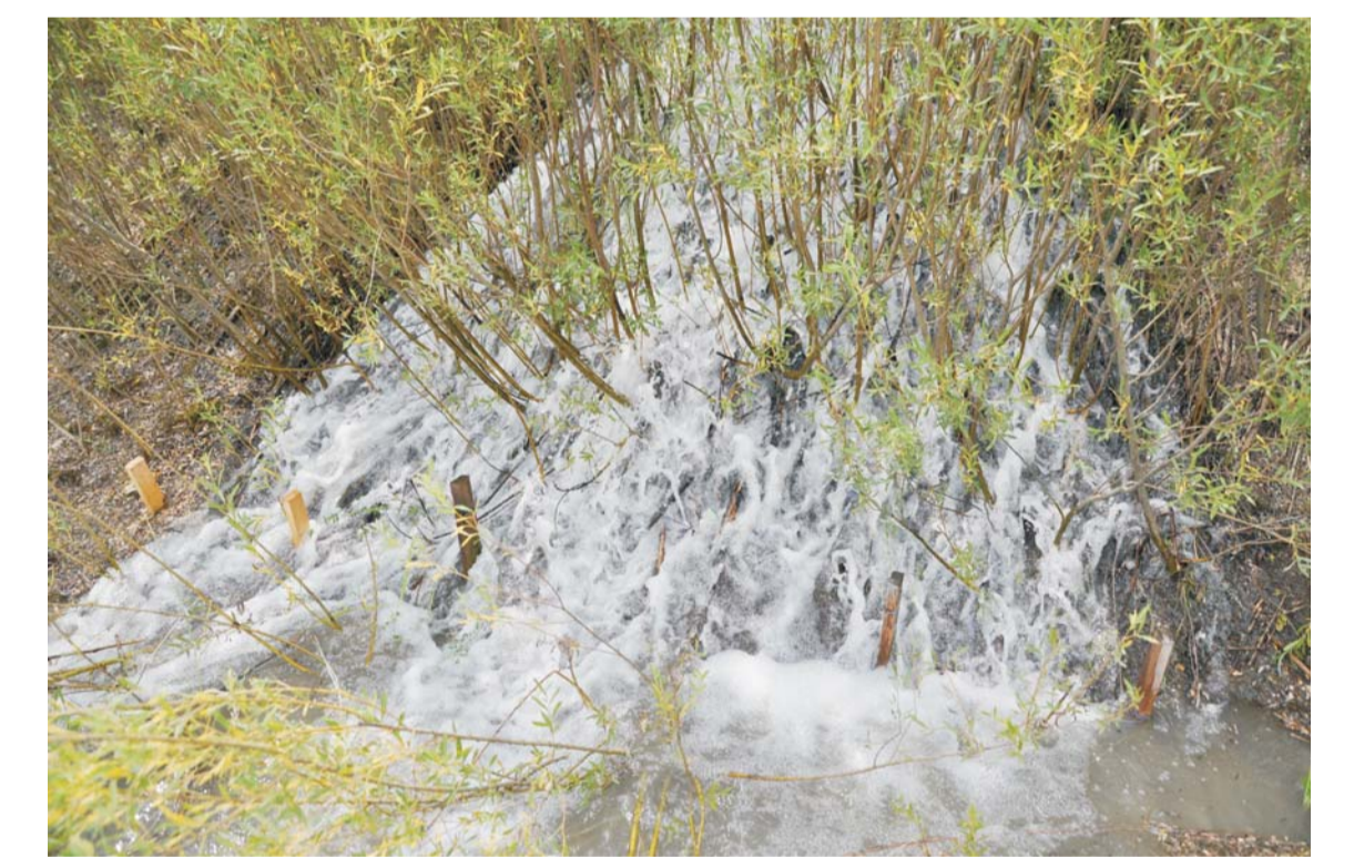
Abb. 7: Überströmung der Weidenspreitlage längs mit 50 l pro Sekunde und lfm Damm (Deutsch-Wagram, Juli 2010).
