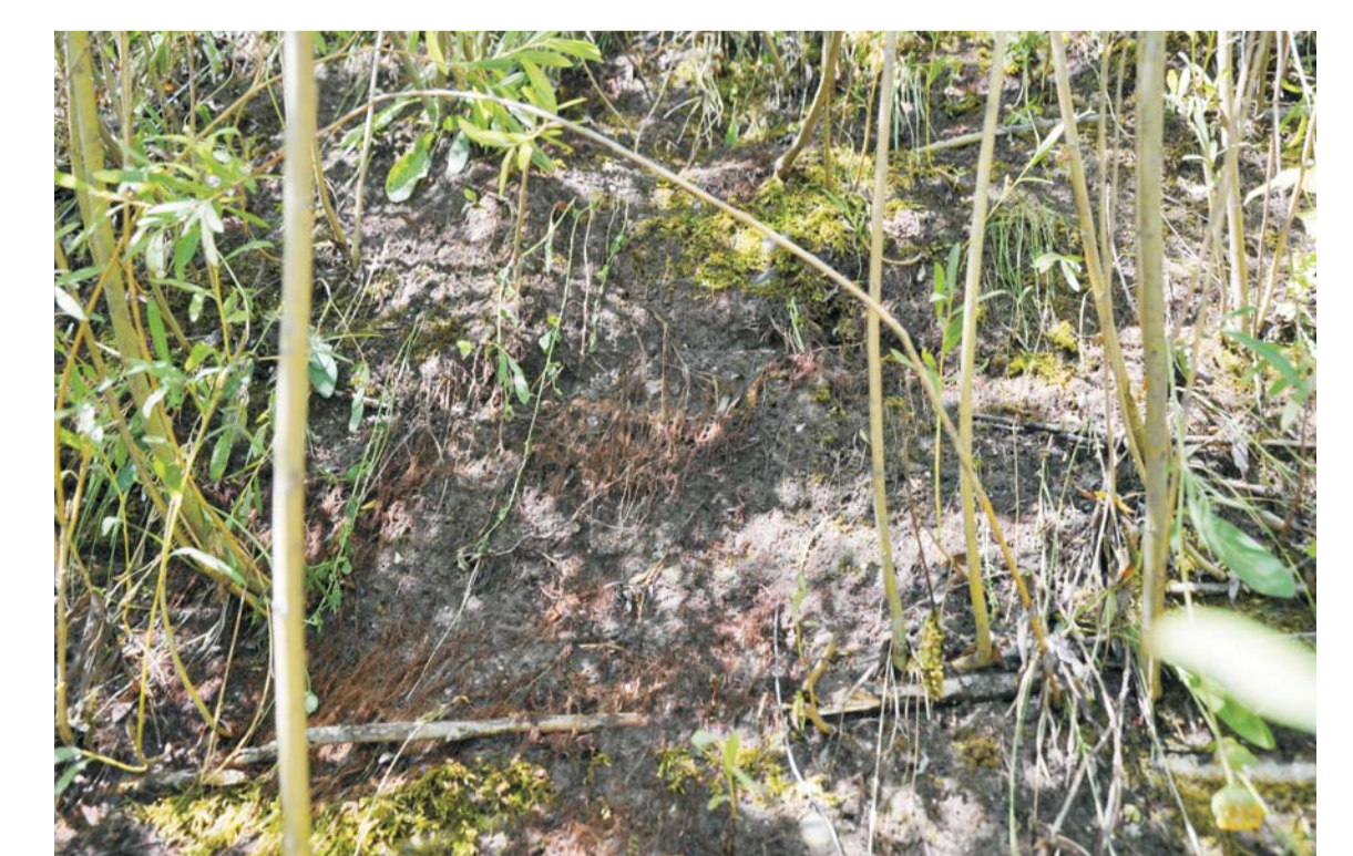
Abb. 9: Weidenspreitlage quer nach 3 Stunden Überströmung und einer Belastung von 50 l/s pro lfm Damm - freigespülte Feinwurzeln (Deutsch-Wagram, Juli 2010).
