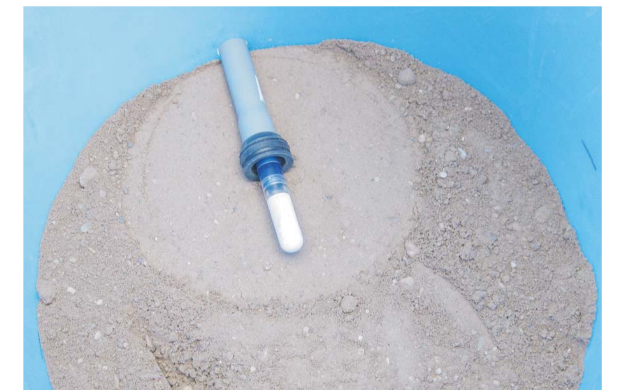
Abb. 6: Tensiometer zur Messung der Bodenwasserspannung (Deutsch-Wagram, Juni 2009).
