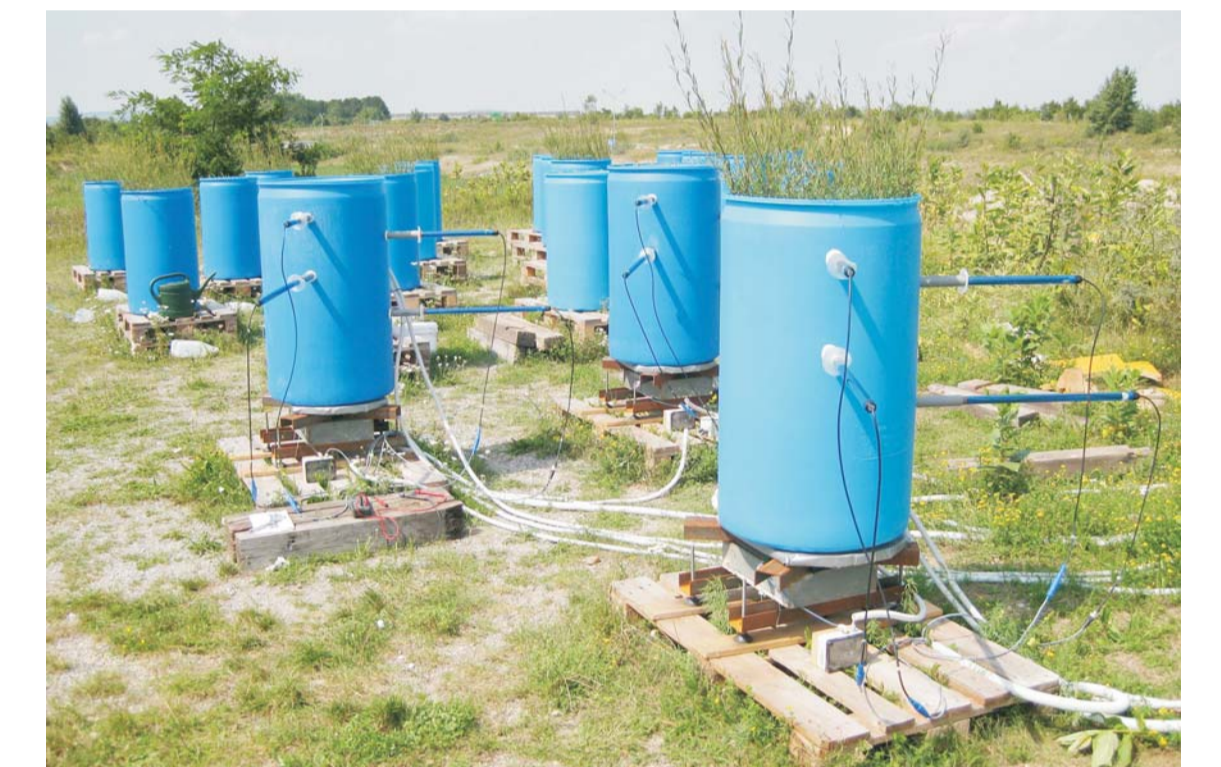
Abb. 4: Die zu wägbaren Lysimetern ausgebauten Versuchsbehälter (Deutsch-Wagram, August 2009)
