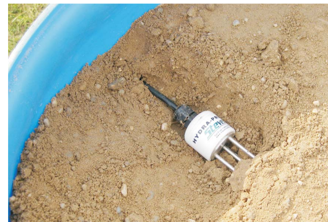
Abb. 5: Bodenwassergehaltssensor und Bodentempersensoren (Deutsch-Wagram, Juni 2009).
