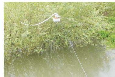
Abb. 4: Ultraschallsensor zur Messung des Wasserspiegels im Becken (Deutsch-Wagram, August 2010)
