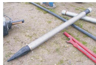
Abb. 2: Pegelrohr vor dem Einbau (Deutsch-Wagram, November 2007)
