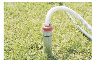
Abb. 3: Pegelrohr mit eingebauter Sonde (Deutsch-Wagram, Juni 2008)
